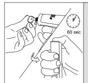
CAUTION: Field end caps must not have any gaps which would allow water penetration. Ensure end cap completely seals end of ColorLINE section. ATTENTION: Les capuchons d'extrémité de champ ne doivent avoir aucun espace qui permettrait la pénétration de l'eau. Assurez-vous que le capuchon d'extrémité est complètement scellé fin de la section ColorLINE.
